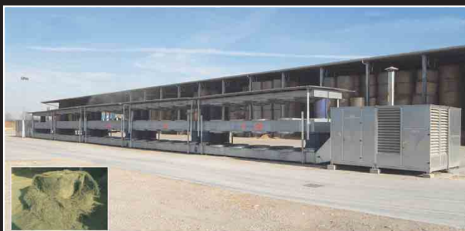
Essiccatoio per foraggio, per 80 balle tonde (Italia) / Hay dryer for 80 round bales (Italy)
